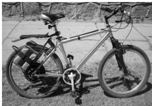
Fig. 3. Foto de Bicicleta Eléctrica con motor instalado en rueda trasera.
