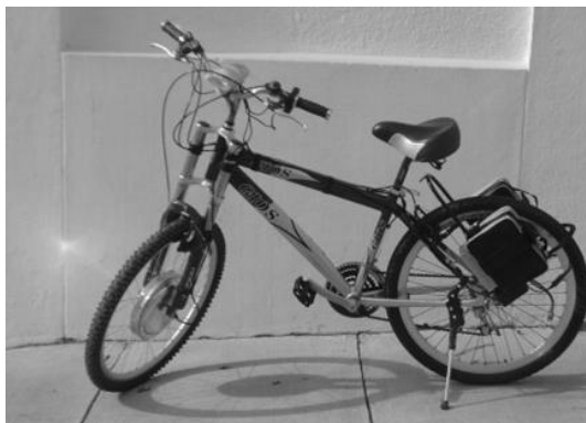
Fig. 4. Foto de Bicicleta Eléctrica con motor instalado en rueda delantera.
