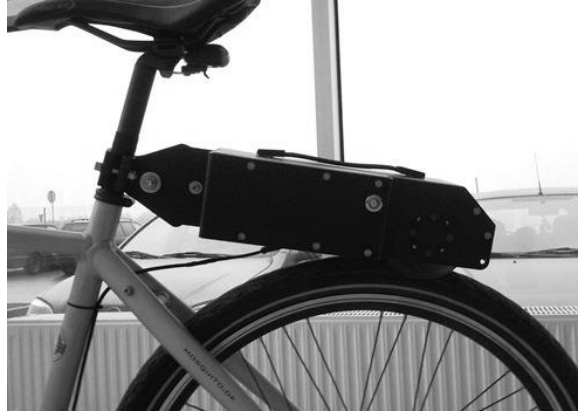
Fig. 5. Foto de Bicicleta con Kit acoplado sin modificar la bicicleta.
