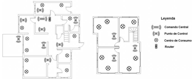
Fig. 8. Plano de asignación de la ubicación de los interruptores donde se encontrarán los diversos puntos de red.
